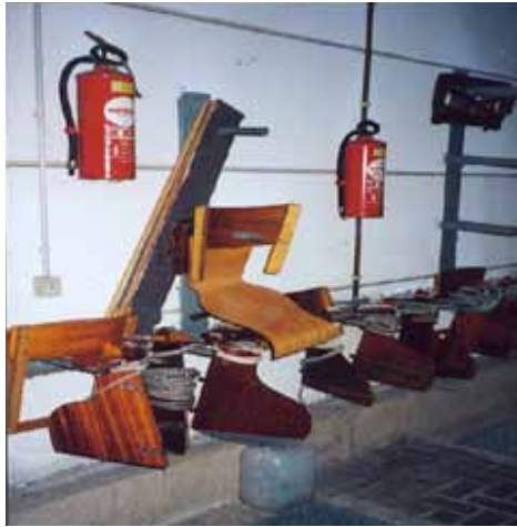
Abb.118: Aufhängung für Steuer und Rückenlehnen, soweit diese lose und nicht fest eingebaut sind. Eine genaue Beschriftung mit den Bootsnamen ist unbedingt notwendig. Wenn es sich einrichten lässt, sollten auch alle anderen dem Boot fest zugeordneten Zubehörteile (Bug- und Heckbodenbretter, Zusatzrollbahnen mit Rollsitzen für fußgesteuertes Rudern) hier eingeordnet werden. Lässt sich das aus Platzgründen nicht einrichten, können diese Dinge auch direkt bei den Booten untergebracht werden.
