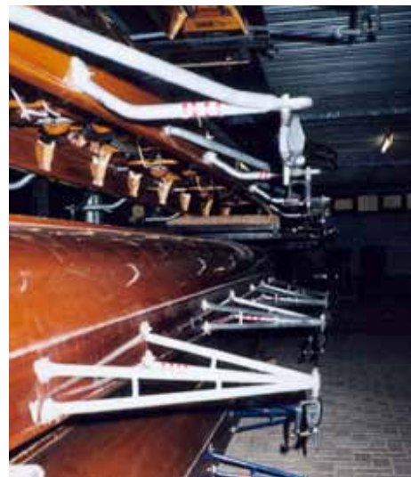
Abb.122: Aufgesteckte Isolierstücke auf den Dollenstiften verringern das Risikovo Bootsschäden beim Einlagern und Herausnehmen der Boote.
